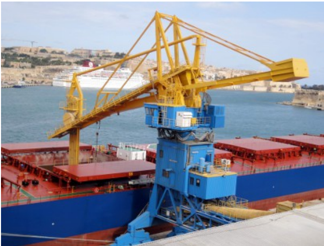
Förderrüssel tief in Kammer der MV Androusa eingetaucht
