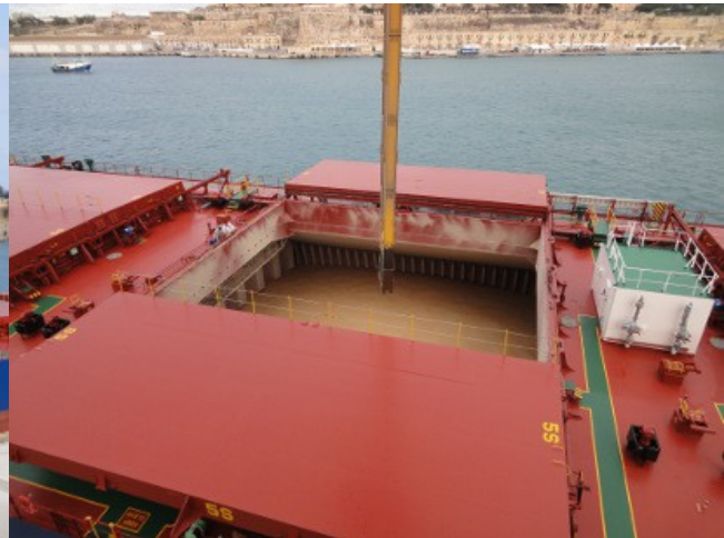
Geöffnete Kammer der MV Androusa und Förderrüssel
