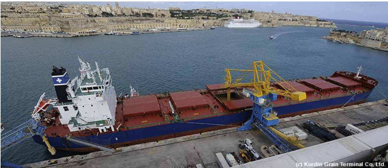
(c) Kordin Grain Terminal Co. Ltd. Beim Entladen der MV Androusa kann Förderrüssel tief in die Kammern eintauchen
