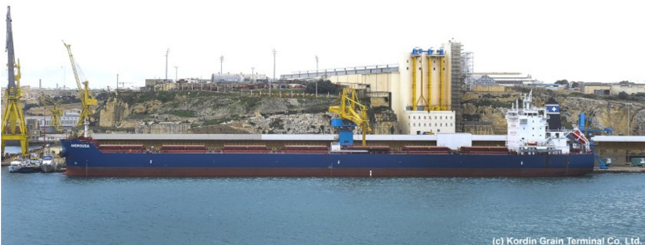
Entladen von 25.000 Tonnen Weizen aus den Kammern der MV Androusa (Durchsatzleistung: bis zu 1.500 Tonnen pro Stunde)
