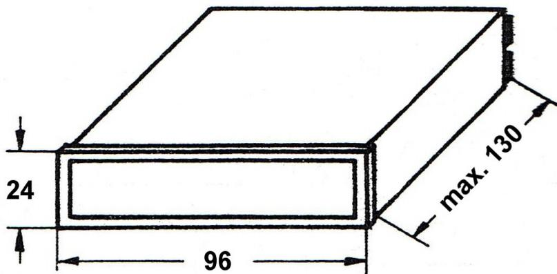
Gehäuseabmessungen in mm
