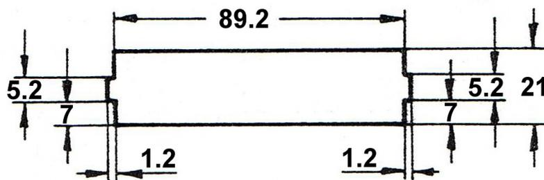
Abmessungen für Schaltschrankausbruch in mm
