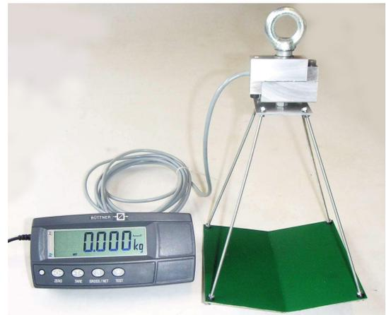
Die elektronische Gewichtsanzeige (LCD) ist bewusst separat und über ein flexibles Kabel mit der Waagenkonstruktion verbunden. Die Spannungsversorgung erfolgt aus der Bordspannung (Fahrzeuggatterie, 12 V), kann aber auch aus Batterien (4 x 1.5 V AA), die in der Rückhaube des Anzeigegerätes untergebracht werden, erfolgen.
